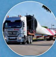
Am 3. September 2013, wurden die Rotorblätter zur Baustelle auf den Weißmoos geliefert. Die Sattelzüge mit einer Länge von über 55 Metern, einer Breite von 4 Metern und eine Höhe von etwa 4,5 Metern erreichten ohne Komplikationen die Baustelle.
