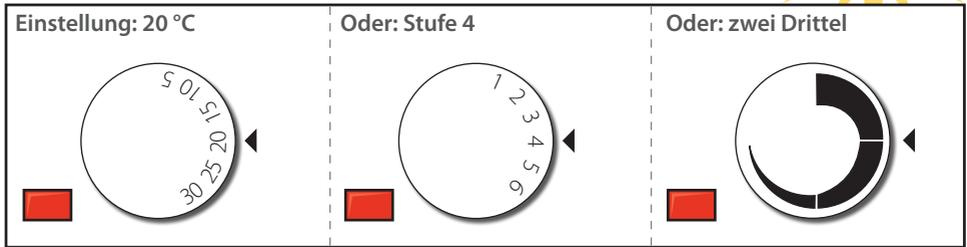
Fast alle Speicherheizungen geben über ein eingebautes Gebläse soviel Wärme ab, wie über den Raumtemperaturregler oder das Thermostat angefordert wird. Der Regler oder der Thermostat schaltet das Gebläse erst wieder ein, wenn die Raumtemperatur unter den eingestellten Wert sinkt. Während des Betriebs leuchtet die rote Kontrollleuchte (falls vorhanden).
