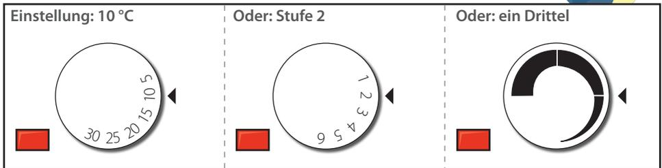
Nachts oder wenn Sie länger abwesend sind, schalten Sie den Regler auf ca. 10 °C (siehe Abbildung). Die extreme Auskühlung des Raumes wird verhindert. Auch beim Lüften können Sie wertvolle Energie sparen, schalten Sie den Regler auf 0°C. Wenn das Gebläse abgeschaltet ist, wird die Wärme nur über die Oberfläche des Gerätes abgegeben.
